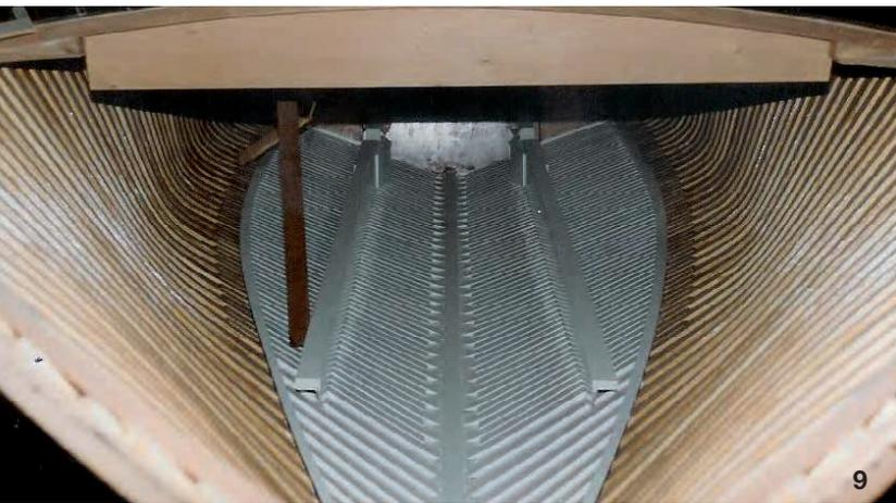
9- Une fois retournée, la coque est grattée, nettoyée des déchets de colle, et les pointes de clous encore apparentes sont minutieusement disquées. On entame alors la mise en peinture.
