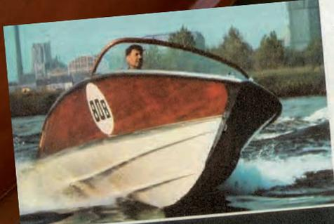
**Coque en « V » modèle 620 - « In-Board »**
